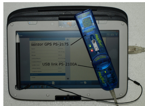
Obr. 2: Zapojení senzoru přes USB link
