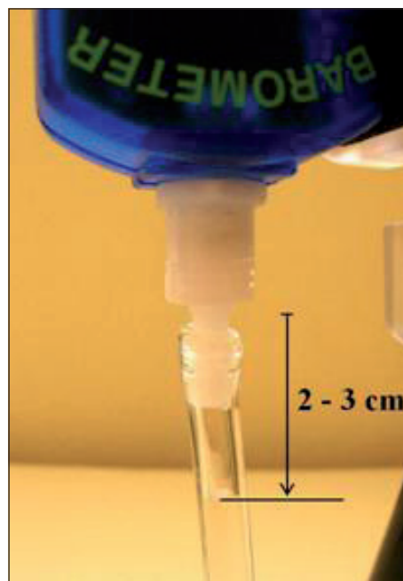
Připojení hadičky k barometru (viz Příprava měření, bod 9)
