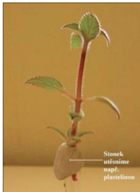
Utěsnění rostliny pomocí plastelíny (viz Příprava měření, bod 7)
